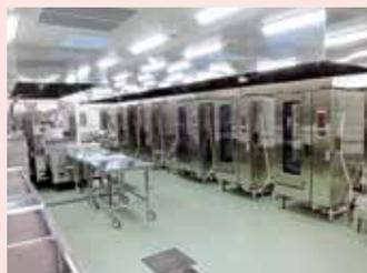
焼物・蒸物ができるパズル方式のスチームコンベクションオープンにより、衛生管理を徹底します
