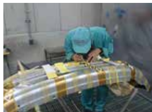
▲バンパーなどの模様は、貼り付けから塗装まで手作業で
