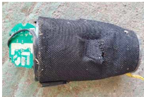
▲発火をした小型のワイヤレススピーカー
