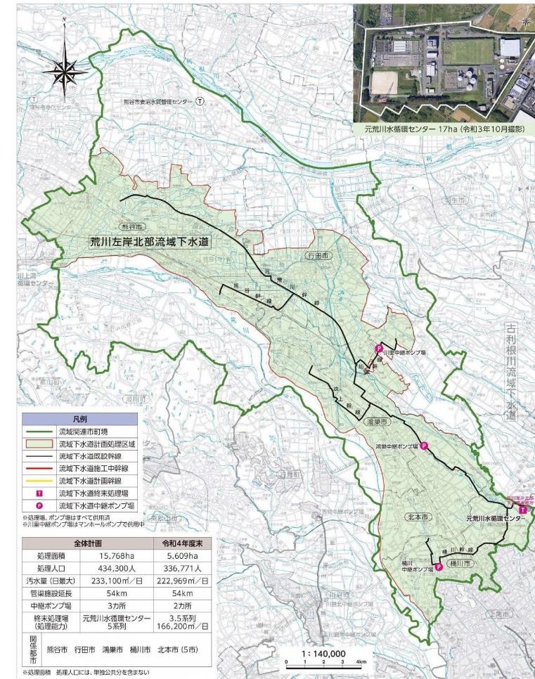
図 22 荒川左岸北部流域下水道の概要と位置図
