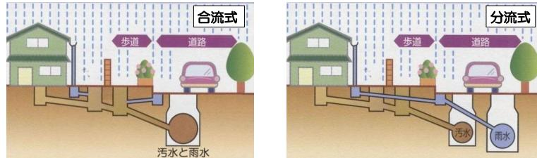
図6 合流式及び分流式のイメージ図
