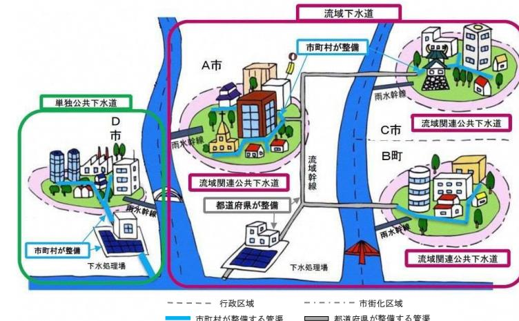
図10 公共下水道と流域下水道のイメージ
