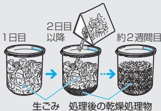
・乾燥処理物がかくはん羽根の周囲に固まった場合は、崩してからその上に生ごみを投入すれば処理できます。
