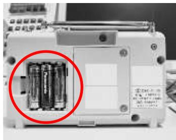
背面のカバーを開けて電池を取り付けます。
