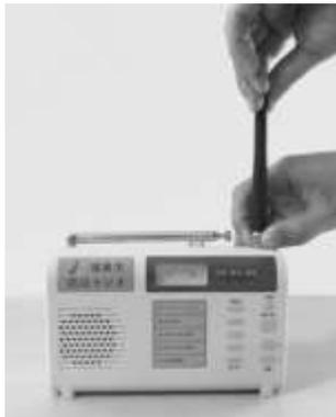
押し込みながら根本の銀の部分ねじ込みます。
