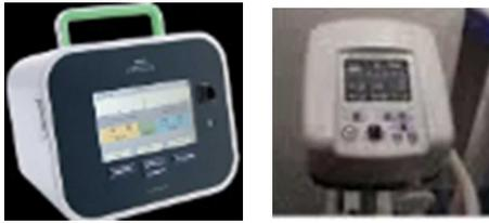
自分で咳をしたり、うまく痰が出せない場合に使用する機械。原理は、気道に陽圧をかけて肺に空気を沢山入れた後に、陰圧で息を吐き出させることで、咳の介助（代用）をして気道内分泌物を除去するのを助けます。繰り返し使用することで、肺の機能を向上させ、感染による肺炎等の肺合併症の予防にもつながります。医療保険上、人工呼吸器を使用している人のみが対象となります。
