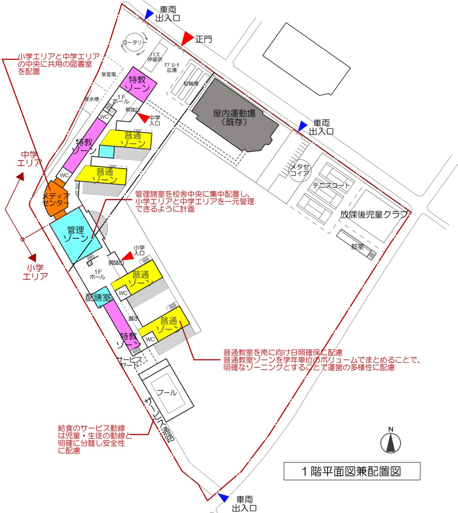
1階平面図兼配置図
