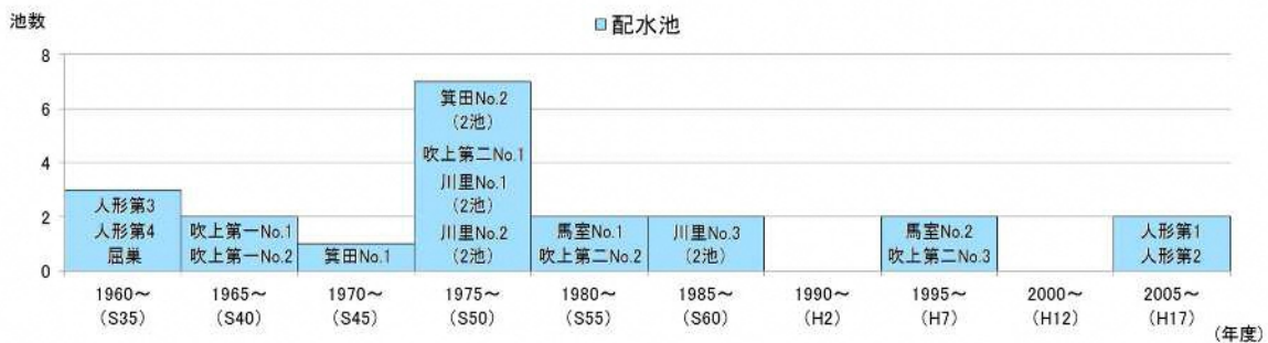
図 31 年代別の配水池の設置状況
